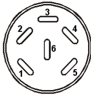
Abbildung 15: Pinbelegung der DIN-Buchse (O) für Option Analogausgänge
