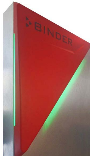
Abbildung 7: Anzeige des Signaldreiecks (störungsfreier Betrieb)
